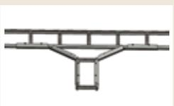
■ Используется для создания в трассе горизонтального Т-отвода. Лестничные лотки подсоединяются к Тройникам соединителями СНЛ, СВЛ, СШЛ. В месте соединения обязательно должна быть опора (кронштейн, подвес и т.п.).
