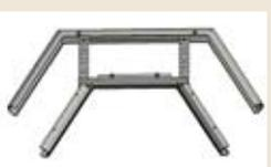
■ Используется для создания в трассе горизонтального поворота на 90°. Лестничные лотки подсоединяются к Поворотам соединителями СНЛ, СВЛ, СШЛ. В месте соединения обязательно должна быть опора (кронштейн, подвес и т.п.).
