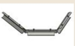
■ Используется для создания Т-отводов и Х-разветвителей. Для формирования Т-отводов применяется 2 Соединителя угловых, для формирования Х-разветвителей применяется 4 Соединителя угловых. Под местом соединения обязательно должна быть опора (кронштейн, подвес и т.п.).
