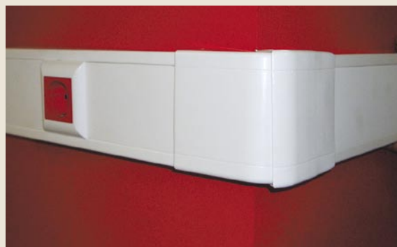
■ Внешние и внутренние углы изменяемые 60-120 градусов. Установите внешний угол. Сдвиньте крышки короба в нужное положение до фиксации под накладкой угла
