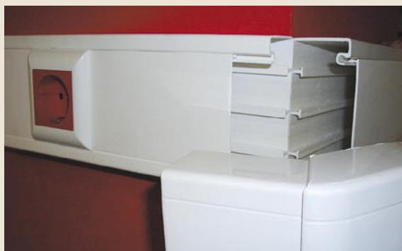
■ Внешние и внутренние углы изменяемые 60-120 градусов. Установите внешний угол. Сдвиньте крышки короба в нужное положение до фиксации под накладкой угла
