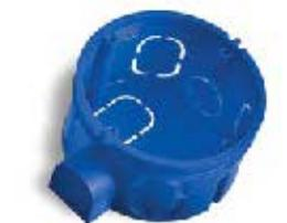
Коробка для подштукатурного монтажа используется в комбинации с гофрированными или гладкими трубами для разветвления кабелей, проводов и установки электроустановочных изделий евростандарта с межвинтовым расстоянием 60 мм.
