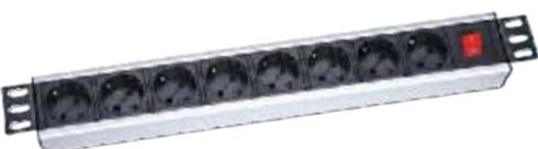
Блок на 8 розеток 16 А 250 В, корпус алюминий, с заземляющими контактами и защитными шторками, с выключателем, размер 19". Кабель 3x1.5 мм, длина 1.8 м
