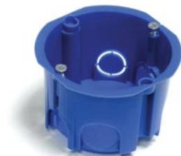
Коробка для подштукатурного монтажа используется в комбинации с гофрированными или гладкими трубами для разветвления кабелей, проводов и установки электроустановочных изделий евростандарта с межвинтовым расстоянием 60 мм. Стыковочные узлы позволяют осуществлять групповой монтаж электроустановочных изделий с межосевым расстоянием 71 мм.
