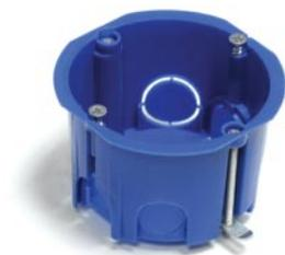
Коробка для подштукатурного монтажа используется в комбинации с гофрированными или гладкими трубами для разветвления кабелей, проводов и установки электроустановочных изделий евростандарта с межвинтовым расстоянием 60 мм. Коробка врезается в полые или гипсокартоновые стены, крепление самонарезаемыми винтами с металлическими лапками.
