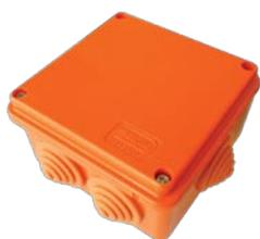
Огнестойкие распределительные коробки серии JBS рекомендуется для применения в составе огнестойких кабельных линий в качестве системы повышения живучести конструкций согласно DIN 4102 часть 12 в сочетании с огнестойким кабелем от 0,15 до 16 мм<sup>2</sup>. Испытания и фактическое время работоспособности коробки с конкретной маркой огнестойкого кабеля и схемой монтажа проводится согласно требованиям ГОСТ Р 53316-2009.
