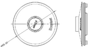
Коробка установочная предназначена для организации посадочного места для любых электроустановочных изделий евростандарта с межвинтовым расстоянием 60 мм и межосевым расстоянием 71 мм при монолитном бетонировании, имеет бортик для монтажа крышки путем защелкивания и вводы под гофрированную трубу  $\varnothing$  20 мм.
