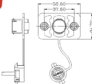
Втулка концевая для пристыковки гофрированных труб к опалубке бетонирования для организации выводов электропроводки из монолита. Втулка концевая состоит из двух соединенных частей с перемычкой, платформа втулки крепится к опалубке гвоздями, саморезами или иным способом для обеспечения надежного крепления крышки на опалубке в двух отверстиях.
