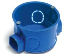
Коробка для подштукатурного монтажа используется в комбинации с гофрированными или гладкими трубами для разветвления кабелей, проводов и установки электроустановочных изделий евростандарта с межвинтовым расстоянием 60 мм.
