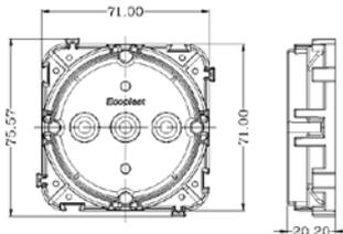
Днище для коробки под заливку в бетон (код 44604)
