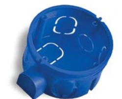
Коробка для подштукатурного монтажа используется в комбинации с гофрированными или гладкими трубами для разветвления кабелей, проводов и установки электроустановочных изделий евростандарта с межвинтовым расстоянием 60 мм.
