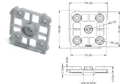
Суппорт-опора является креплением для коробок установочных при заливке в бетон на встречную опалубку при монолитном бетонировании. Для стыковки суппорта-опоры с коробкой установочной используется отрезок жесткой гладкой трубы  $\varnothing$  20 мм (в комплект поставки не входит, и нарезается на месте по ширине монолитной стены). Имеется 4 отверстия для крепления к арматуре стальными или ПА хомутами или саморезами (гвоздями) в случае готовой опорной стены.
