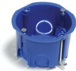
Коробка для подштукатурного монтажа используется в комбинации с гофрированными или гладкими трубами для разветвления кабелей, проводов и установки электроустановочных изделий евростандарта с межвинтовым расстоянием 60 мм. Коробка врезается в полые или гипсокартоновые стены, крепление самонарезаемыми винтами с металлическими лапками.
