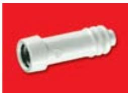
■ Муфта типа «труба-труба» герметичная для гофрированной армированной трубы выполнена из АБС пластика или ПВХ самозатухающего. Цвет: RAL 7035. Класс защиты IP65. Предназначена для герметичного соединения труб гофрированных/армированных с жесткими гладкими трубами при открытой проводке во влажных и сырых помещениях (пример: подвалы, мойки, рабочая зона общ. кухни) и снаружи зданий. Муфта является переходом от трубы армированной меньшего диаметра к трубе жесткой большего диаметра.
