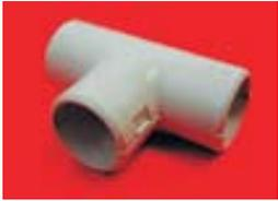
■ Тройник Т-образный типа «труба-труба» для гофрированной или жесткой гладкой трубы выполнен из АБС пластика. Цвет: RAL 7035. Предназначен для соединения 3-х гофрированных или жестких труб одного диаметра под углом 90° относительно друг друга. Класс защиты IP40. Угол, как правило, используется для соединения жестких гладких труб, образуя Т-образные ответвления под 90° в жестком исполнении.
