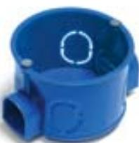
Коробка для подштукатурного монтажа используется в комбинации с гофрированными или гладкими трубами для разветвления кабелей, проводов и установки электроустановочных изделий евростандарта с межвинтовым расстоянием 60 мм.
