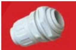
■ Переходник типа «армированная труба-коробка» выполнена из АБС пластика или ПВХ самозатухающего. Цвет: RAL 7035. Класс защиты IP65. Предназначен для уплотнения места ввода гибкой армированной трубы в оболочку электротехнического оборудования (ответвительные коробки, щиты и т.д.), или с корпусами машин и агрегатов через отверстия с метрической резьбой, или через отверстия без резьбы, с помощью контргайки и резиновой прокладки
