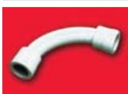
■ Поворот единый 90° типа «труба-труба» герметичный для жесткой гладкой трубы выполнен из АБС пластика или ПВХ самозатухающего. Цвет: RAL 7035. Класс защиты IP66. Предназначен для сверхгерметичного соединения труб жестких гладких с трубами того же диаметра при открытой проводке во влажных и сырых помещениях (пример: подвалы, мойки, рабочая зона общ. кухни) и снаружи зданий с очень высоким требованием по герметичности.
