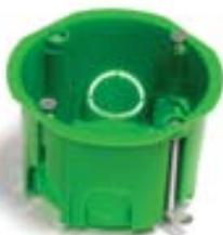
Коробка для подштукатурного монтажа используется в комбинации с гофрированными или гладкими трубами для разветвления кабелей, проводов и установки электроустановочных изделий евростандарта с межвинтовым расстоянием 60 мм. Коробка врезается в полые или гипсокартоновые стены, крепление самонарезаемыми винтами с металлическими лапками.
