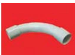
■ Поворот на 90° (единый) типа «труба-труба» для гофрированной или жесткой гладкой трубы выполнен из АБС пластика. Цвет: RAL 7035. Предназначен для соединения труб гофрированных или жестких под углом 90°. Класс защиты IP40. Угол, как правило, используется для соединения жестких гладких труб, образуя обвод под 90° в жестком исполнении.
