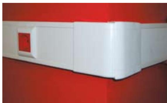
■ Внешние и внутренние углы изменяемые 60-120 градусов. Установите внешний угол. Сдвиньте крышки короба в нужное положение до фиксации под накладкой угла
