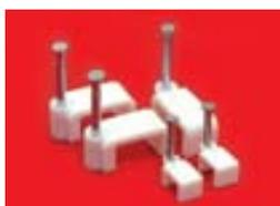
■ Скоба пластиковая с гвоздем в комплекте применяется для крепления кабелей или проводов плоской формы к поверхностям стен, потолков и несущих конструкций. Скоба имеет П-образную форму и выполнена из полиэтилена. Цвет: белый / серый / черный. Часто является необходимым аксессуаром при прокладке кабельных сетей и систем гофрированных или жестких труб при построении или реконструкции электропроводки.
