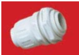
■ Переходник типа «армированная труба-коробка» выполнена из АБС пластика или ПВХ самозатухающего. Цвет: RAL 7035. Класс защиты IP65. Предназначен для уплотнения места ввода гибкой армированной трубы в оболочку электротехнического оборудования (ответвительные коробки, щиты и т.д.), или с корпусами машин и агрегатов через отверстия с резьбой PG, или через отверстия без резьбы, с помощью контргайки и резиновой прокладки.
