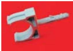
■ Держатель с дюбелем для гофрированной или жесткой гладкой трубы выполнен из АБС пластика. Цвет: RAL 7035. Предназначен для крепления трубы гофрированной или жесткой к поверхности стен, потолков, полов или перегородок и имеет ответвление в виде дюбеля.
