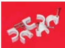
■ Скоба пластиковая с гвоздем в комплекте применяется для крепления кабелей или проводов к поверхностям стен, потолков и несущих конструкций. Скоба имеет скругленную форму и выполнена из полиэтилена. Цвет: белый /серый/черный. Часто является необходимым аксессуаром при прокладке кабельных сетей и систем гофрированных или жестких труб при построении или реконструкции электропроводки.
