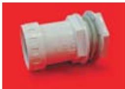
■ Муфта «труба-коробка» для гофрированной или жесткой гладкой трубы выполнена из АБС пластика. Цвет: RAL 7035. Класс защиты IP65. Предназначена для герметичного соединения жестких труб при открытой проводке во влажных и сырых помещениях (пример: подвалы, мойки, рабочая зона общ. кухни) или снаружи зданий. Муфта является переходом от гладкой трубы непосредственно в распределительную коробку или силовой щит.
