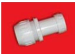
■ Муфта типа «труба-труба» герметичная для жесткой армированной трубы выполнена из АБС пластика или ПВХ самозатухающего. Цвет: RAL 7035. Класс защиты IP65. Предназначен для герметичного соединения труб гофрированных /армированных с жесткими гладкими трубами при открытой проводке во влажных и сырых помещениях (пример: подвалы, мойки, рабочая зона общ. кухни) и снаружи зданий. Муфта является переходом от трубы армированной к трубе жесткой с сохранением диаметра.
