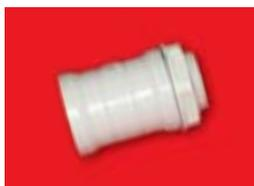
■ Муфта типа «труба-коробка» сверхгерметичная для гладких жестких труб выполнена из АБС пластика или ПВХ самозатухающего. Цвет: RAL 7035. Класс защиты IP66. Предназначена для спец.герметичного соединения жестких гладких труб с распределительными коробками или силовыми щитами при открытой проводке во влажных и сырых помещениях (пример: подвалы, мойки, рабочая зона общ. кухни) и снаружи зданий при решении задачи обеспечения высокой герметичности в системе проводки жестких гладких труб.
