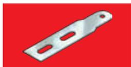
■ Шарнирное соединение объединяет в себе функции соединителя и угла-поворота. Оно позволяет изменять направление кабельного канала в вертикальной плоскости на произвольный угол. По сравнению с вертикальными углами 90° (УВ и УВН) шарнирное соединение является более простым и экономичным решением. Оно состоит из двух комплектов планок ПШС, соединенных винтом и гайкой.
