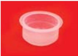
■ Заглушка для гофрированной трубы выполнена из полистирола или ПЭ. Цвет: белый / прозрачный. Предназначена для закрытия конца гофрированной трубы при проведении дополнительных линий (консервировании) или укладки трубы до момента окончания отделочных работ или работ по заливке гофрированных труб в бетон.
