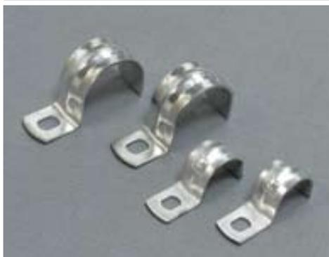
■ Скоба оцинкованная однолапковая применяется для крепления кабелей или проводов к поверхностям стен, потолков и несущих конструкций. Имеет скругленную форму и выполнена из легированной нержавеющей стали. Цвет: материала – сталь/желтый. Имеет отверстие (одно или два) для крепления к стене. Часто является необходимым аксессуаром при прокладке кабельных сетей и систем гофрированных или жестких труб при построении или реконструкции электропроводки.
