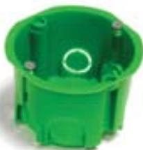
Коробка для подштукатурного монтажа используется в комбинации с гофрированными или гладкими трубами для разветвления кабелей, проводов и установки электроустановочных изделий евростандарта с межвинтовым расстоянием 60 мм. Стыковочные узлы позволяют осуществлять групповой монтаж электроустановочных изделий с межосевым расстоянием 71 мм.
