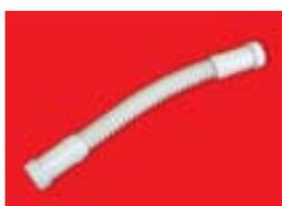
■ Гибкий поворот для соединения жестких труб под произвольным углом. Выполнен из АБС пластика или ПВХ самозатухающего. Цвет: RAL 7035. Класс защиты IP65. Предназначен для герметичного соединения труб жестких гладких при открытой проводке во влажных и сырых или пыльных помещениях (пример: подвалы, мойки, рабочая зона общ. кухни, склады) и снаружи зданий. Гибкий поворот обеспечивает свободный радиус угла поворота при соединении жестких труб в зонах с повышенным содержанием влаги и пыли.
