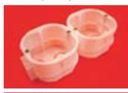
Имеют степень защиты: IP20 или IP40. Могут соединяться в ряд (имеются специальные выводы для стыковки коробки с коробкой). Все установочные коробки данного типа служат для установки электроустановочных изделий (розеток / выключателей и т.д. различных стандартов) в капитальные стены (бетон/ кирпич и т.д.). Имеют современный дизайн и отвечают требованиям стандартов безопасности.
