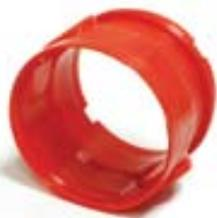
Корпус коробки предназначен для увеличения глубины установочных коробок и коробок потолочных при заливке в бетон, имеет бортик для монтажа крышки путем защелкивания и вводы под гофрированную трубу  $\varnothing$  20 мм.
