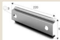
■ Используется для прямого жесткого соединения лестничных лотков, и подсоединения 90°-поворотов, Т-отводов, Х-разветвителей. Соединяет лотки изнутри, фиксируется болтами (входят в комплект).
