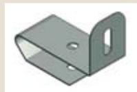
■ Используется для вертикального и горизонтального монтажа лестничных лотков к стене. Кронштейн КСЛВ устанавливается изнутри лестницы. Для фиксации бокового профиля в кронштейне стеновом используется болтовой комплект М8. В качестве крепежа к стене используются анкерные болты М10.
