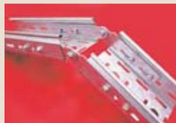
■ Шарнирное соединение объединяет в себе функции соединителя и угла-поворота. Оно позволяет изменять направление кабельного канала в вертикальной плоскости на произвольный угол. По сравнению с вертикальными углами 90° (УВ и УВН) шарнирное соединение является более простым и экономичным решением. Оно состоит из двух комплектов планок ПШС, соединенных винтом и гайкой.
