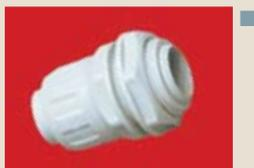
■ Переходник типа «армированная труба-коробка» выполнена из АБС пластика или ПВХ самозатухающего. Цвет: RAL 7035. Класс защиты IP65. Предназначен для уплотнения места ввода гибкой армированной трубы в оболочку электротехнического оборудования (ответительные коробки, щиты и т.д.), или с корпусами машин и агрегатов через отверстия с резьбой PG, или через отверстия без резьбы, с помощью контргайки и резиновой прокладки.
