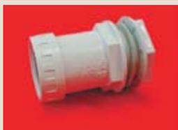
■ Муфта «труба-коробка» для гофрированной или жесткой гладкой трубы выполнена из АБС пластика. Цвет: RAL 7035. Класс защиты IP65. Предназначена для герметичного соединения жестких труб при открытой проводке во влажных и сырых помещениях (пример: подвалы, мойки, рабочая зона общ. кухни) или снаружи зданий. Муфта является переходом от гладкой трубы непосредственно в распределительную коробку или силовой щит.
