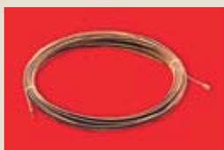
■ Протяжка используется для протягивания кабелей и проводов внутри труб гофрированных и/или жестких (при необходимости) в случае, если гофрированная труба не имеет собственной протяжки в виде стального троса. Протяжка для кабеля стальная выполнена из легированной стали в виде пружины и имеет высокий срок службы. Обычно позволяет не использовать гофрированные трубы с собственной протяжкой. Таким образом, данное решение является наиболее экономным.
