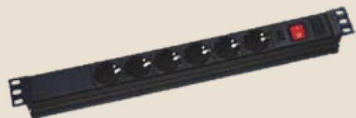
**Блок на 8 розеток 16 А 250 В, корпус ПВХ, с заземляющими контактами и защитными шторками, с выключателем, размер 19". Кабель 3х1.5 мм, длина 2.15 м**
