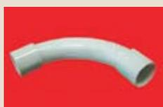
Поворот на 90° (единый) типа «труба-труба» для гофрированной или жесткой гладкой трубы выполнен из АБС пластика. Цвет: RAL 7035. Предназначен для соединения труб гофрированных или жестких под углом 90°. Класс защиты IP40. Угол, как правило, используется для соединения жестких гладких труб, образуя обвод под 90° в жестком исполнении.
