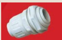
■ Переходник типа «армированная труба-коробка» выполнена из АБС пластика или ПВХ самозатухающего. Цвет: RAL 7035. Класс защиты IP65. Предназначен для уплотнения места ввода гибкой армированной трубы в оболочку электротехнического оборудования (ответительные коробки, щиты и т.д.), или с корпусами машин и агрегатов через отверстия с метрической резьбой, или через отверстия без резьбы, с помощью контргайки и резиновой прокладки
