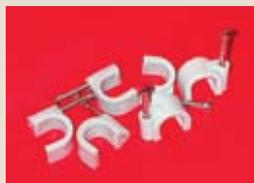
■ Скоба пластиковая с гвоздем в комплекте применяется для крепления кабелей или проводов к поверхностям стен, потолков и несущих конструкций. Скоба имеет скругленную форму и выполнена из полиэтилена. Цвет: белый /серый/черный. Часто является необходимым аксессуаром при прокладке кабельных сетей и систем гофрированных или жестких труб при построении или реконструкции электропроводки.
