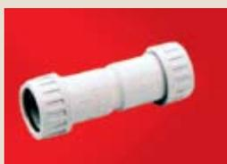
■ Муфта типа ТРУБА-ТРУБА герметичная для жесткой гладкой трубы выполнена из АБС пластика или ПВХ самозатухающего. Цвет: RAL 7035. Класс защиты IP65. Предназначена для герметичного соединения труб жестких гладких с трубами того же диаметра при открытой проводке во влажных и сырых помещениях (пример: подвалы, мойки, рабочая зона общ. кухни) и снаружи зданий с высоким требованием по герметичности – IP65.
