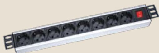
**Блок на 8 розеток 16 А 250 В, корпус алюминий, с заземляющими контактами и защитными шторками, с выключателем, размер 19". Кабель 3х1.5 мм, длина 1.8 м**
