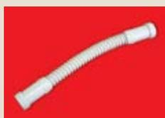
Гибкий поворот для соединения жестких труб под произвольным углом. Выполнен из АБС пластика или ПВХ самозатухающего. Цвет: RAL 7035. Класс защиты IP65. Предназначен для герметичного соединения труб жестких гладких при открытой проводке во влажных и сырых или пыльных помещениях (пример: подвалы, мойки, рабочая зона общ. кухни, склады) и снаружи зданий. Гибкий поворот обеспечивает свободный радиус угла поворота при соединении жестких труб в зонах с повышенным содержанием влаги и пыли.
