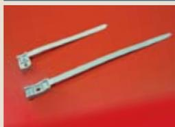
■ Хомутный держатель со стяжкой (хомутом) универсальный для гофрированных, армированных и гладких жестких труб. Выполнен из АБС пластика или ПВХ самозатухающего. Цвет: RAL 7035. Может использоваться как для труб диаметром 16 мм, так и выше по диапазону приращения окружности, до 63 мм. Его отличие от обычных клипс (держателей) заключается в его универсальности, т.е. один типоразмер хомутного держателя можно использовать на 4 сечения труб.
