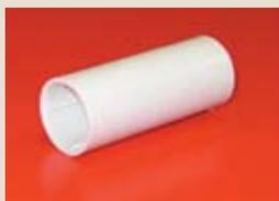
■ Муфта ТРУБА-ТРУБА с ограничителем для гофрированной или жесткой гладкой трубы выполнена из АБС пластика. Цвет: RAL 7035. Предназначена для соединения труб гофрированных или жестких. Класс защиты IP40. Муфта является стыковочным элементом на стык двух гофрированных или жестких гладких труб одного диаметра.
