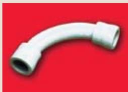
■ Поворот единый 90° типа «труба-труба» герметичный для жесткой гладкой трубы выполнен из АБС пластика или ПВХ самозатухающего. Цвет: RAL 7035. Класс защиты IP66. Предназначен для сверхгерметичного соединения труб жестких гладких с трубами того же диаметра при открытой проводке во влажных и сырых помещениях (пример: подвалы, мойки, рабочая зона общ. кухни) и снаружи зданий с очень высоким требованием по герметичности.
