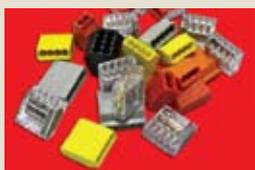
■ Предназначены для присоединения и ответвления одножильных проводников из меди и алюминия или многожильного медного провода с наконечником в электрических цепях переменного тока с частотой 50 Гц напряжением до 380 В. Клеммы применяются в распределительных коробках.
