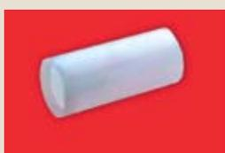
■ Муфта ТРУБА-ТРУБА для гофрированной трубы выполнена из полистирола или ПЭ. Цвет: белый / прозрачный или RAL 7035. Предназначена для соединения труб гофрированных. Класс защиты IP40. Муфта является стыковочным элементом на стык двух гофрированных труб одного диаметра.
